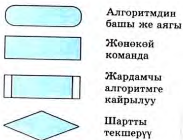
63-сүрөт. Блок-схеманын элементтери жана циклдин структурасы.
