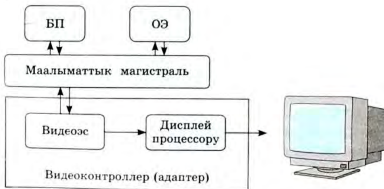
128-сүрөт. Компьютердин графикалык системасынын схемасы.
