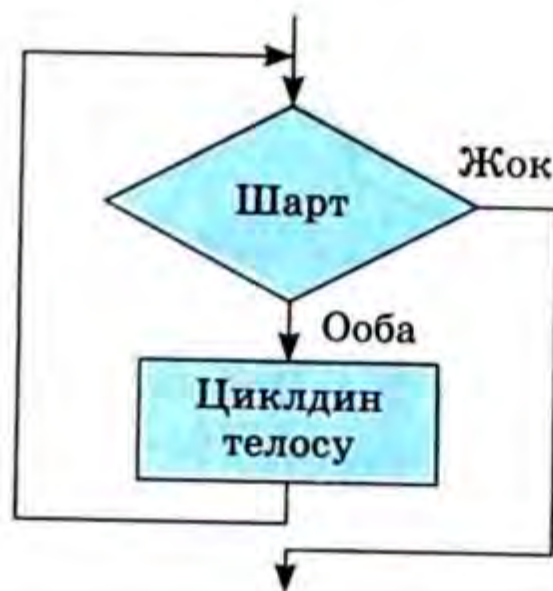
63-сүрөт. Блок-схеманын элементтери жана циклдин структурасы.
