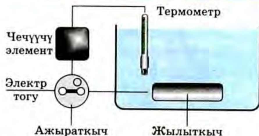
44-сүрөт. Суунун туруктуу температурасын кармап туруучу түзүлүш.
