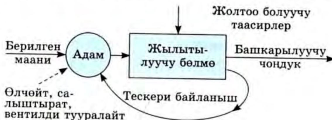
48-сүрөт. 47-сүрөттөгү системаны жөнгө салуунун функциялык схемасы.
