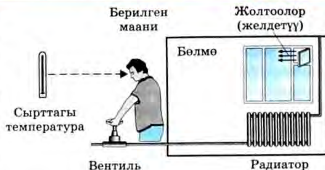
45-сүрөт. Көчөнүн температурасына жараша бөлмөдөгү температураны башкаруу.
