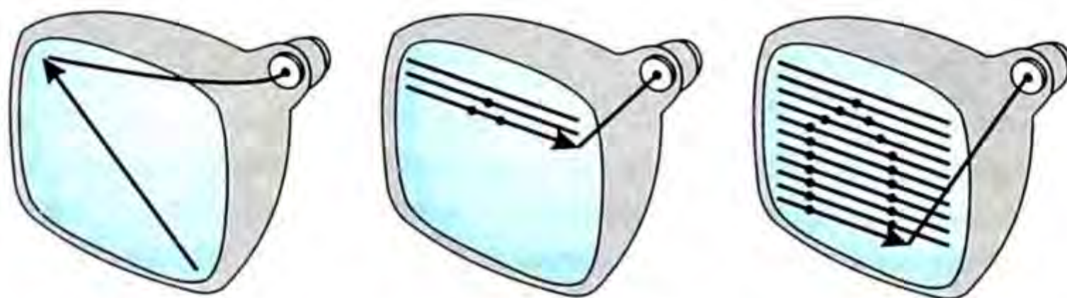
129-сүрөт. Электрон-нур түтүгүндө растрдык сүрөттөлүштү алуу.
