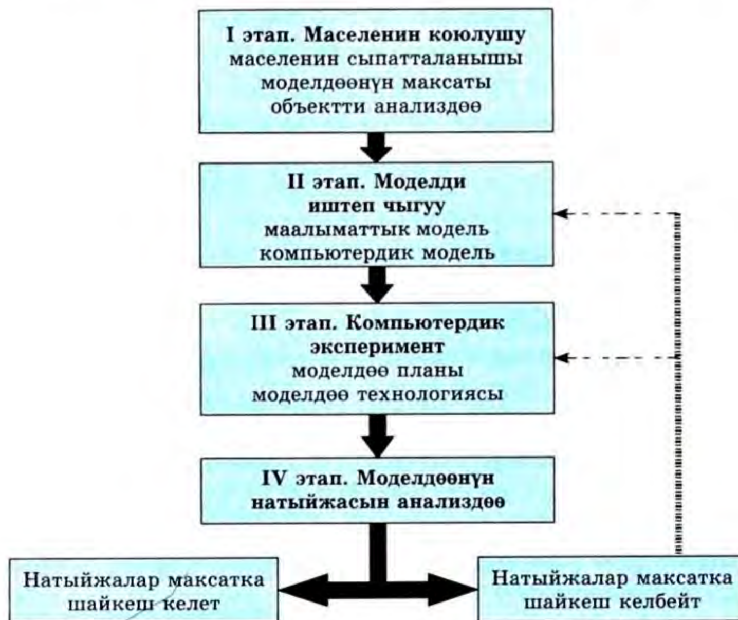
118-сүрөт. Компьютердик моделдөөнүн этаптары.
