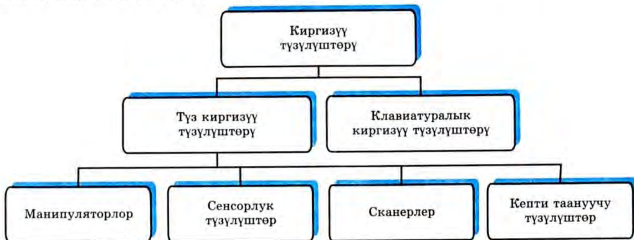
98-сүрөт. Киргизүүчү түзүлүштөрдүн классификациясы.
