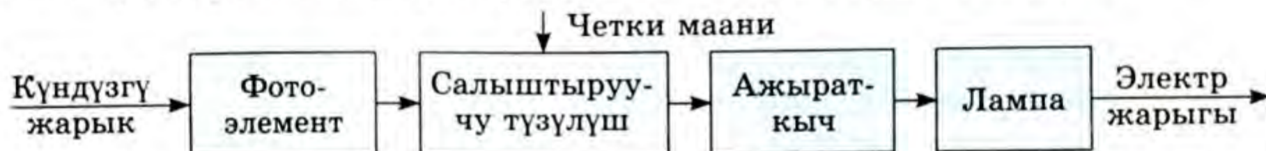
43-сүрөт. Көзөмөлдөөчү системанын функциялык схемасы (фотоэлемент колдонулган жарык берүүчү түзүлүш).
