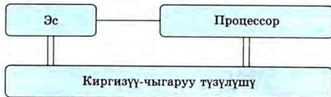
9-сүрөт. ЭЭМдин жалпы принциптеги схемасы.
