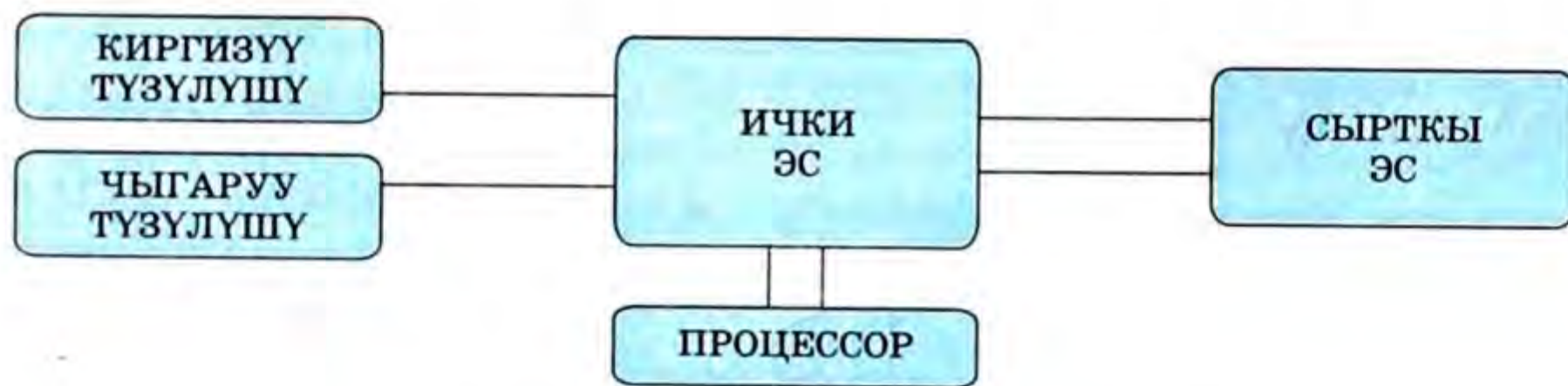
79-сүрөт. Компьютердин түзүлүштөрүнүн схемасы.
