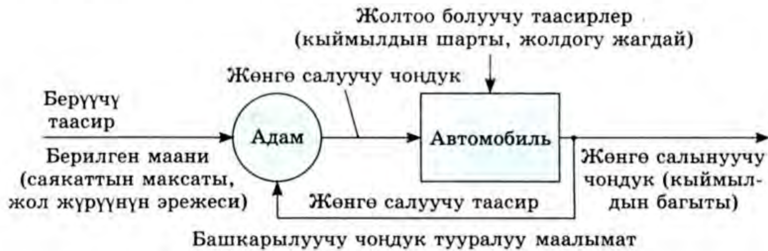
49-сүрөт. Автомобилди башкаруу – жөнгө салуунун туюк контуру.
