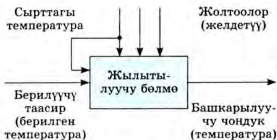
46-сүрөт. 45-сүрөттөгү көзөмөлдөөчү системанын функциялык схемасы.
